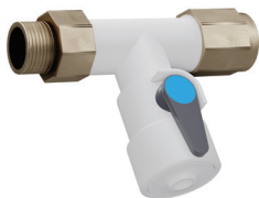
Kątowy zawór odcinający z zaworem zwrotnym, gwintem G3/8" i szybkozłączką do wężyka wodnego 1/4"
